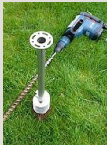
SDS-Max Boorhamer + SDS-Max Betonboor Comfortabele handboor, geschikt om de grond voor te boren.
