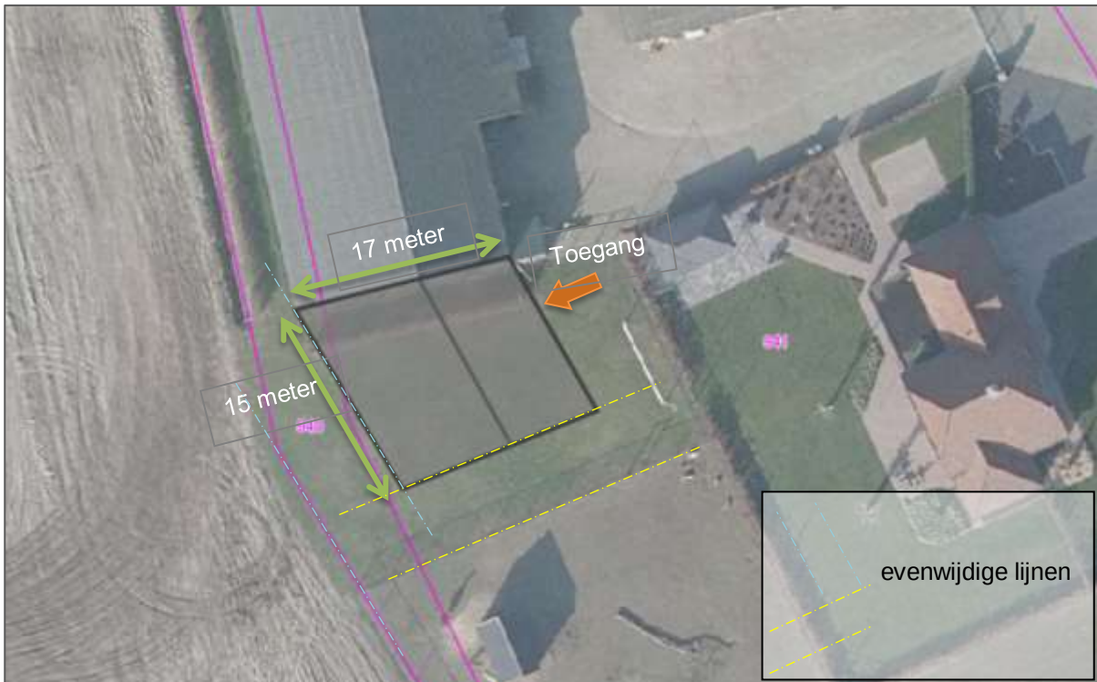
Figuur 8. Beoogde situatie met maatvoering en toegang
