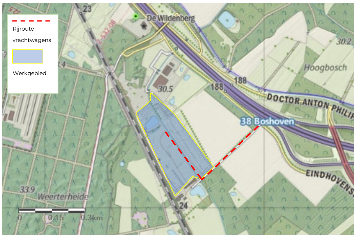
Figuur 17. De verwachte aanvoer van grond en het werkgebied van de grondverzetmachines. In het noordelijke deel van het plangebied (buiten het blauw gemarkeerde werktein) zullen geen activiteiten plaatsvinden.
