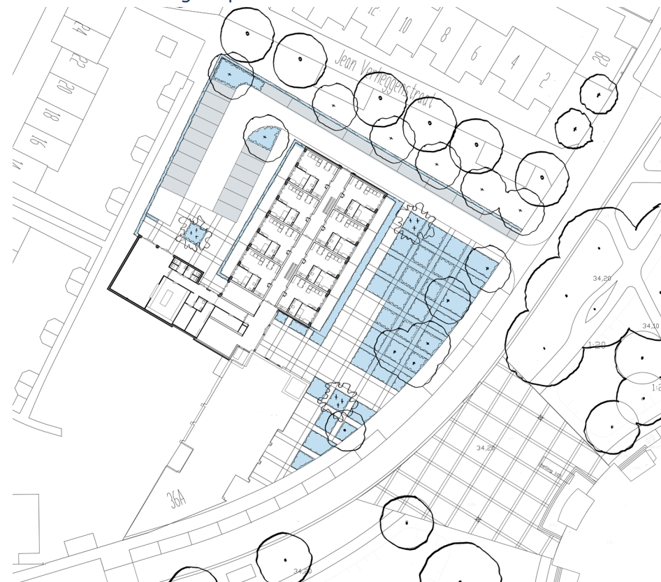
Schema afwatering: dakoppervlak in koffers onder parkeervakken en verhard oppervlak in hagen en plantvakken
