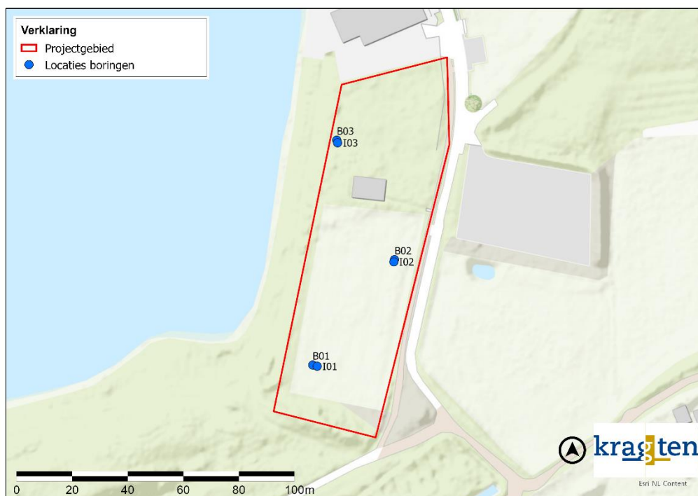
Figuur 11 locaties boringen en infiltratiemetingen
