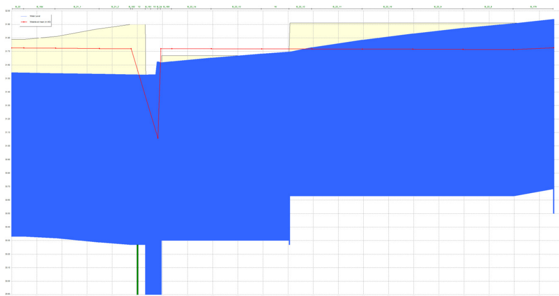
Figuur 15: lengteprofiel over de Oude Lossing tot Bocholterweg (blauw is huidige situatie, rood is ontwerp) bij maximale afvoer (15-11-2010).
