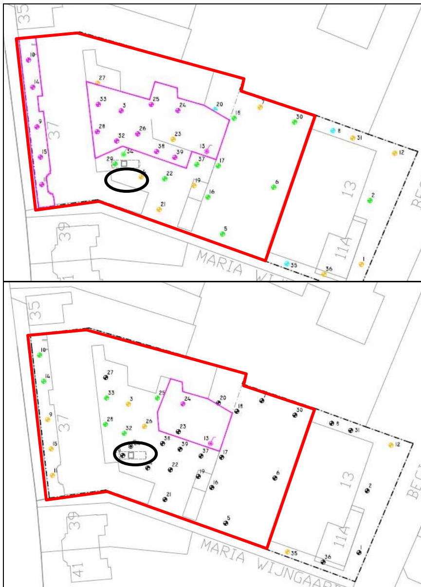
Figuur 10: Boorpuntenkaart van het milieukundig booronderzoek. Boven: de concentraties zware metalen binnen 0-50 cm –mv (paarse kader). Onder: de concentraties zware metalen binnen 50-100 cm –mv (paarse kader). De locatie van de ondergrondse tank staat met het zwarte ovaal aangegeven. Het huidige plangebied is aangegeven met het rode kader (Bron: Van Horen en De Vaan 2016 (Milieutechnisch Adviesbureau Heel BV 084WRT/16/R1).
