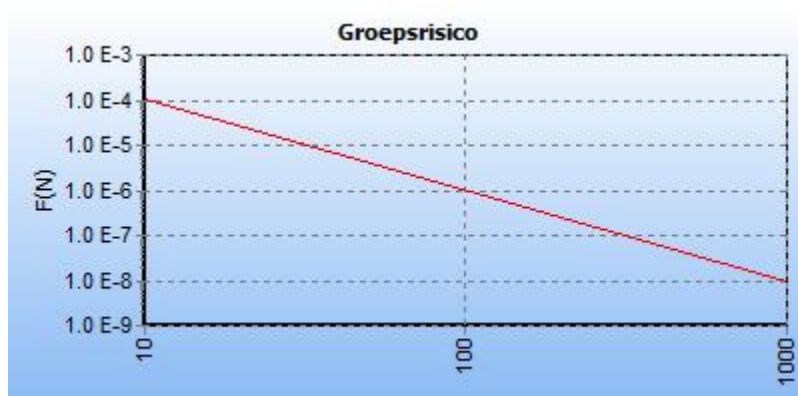
5.3 Figuur 5.3 FN curve voor A-585 van N.V. Nederlandse Gasunie voor de kilometer tussen stationing 50470.00 en stationing 51470.00
