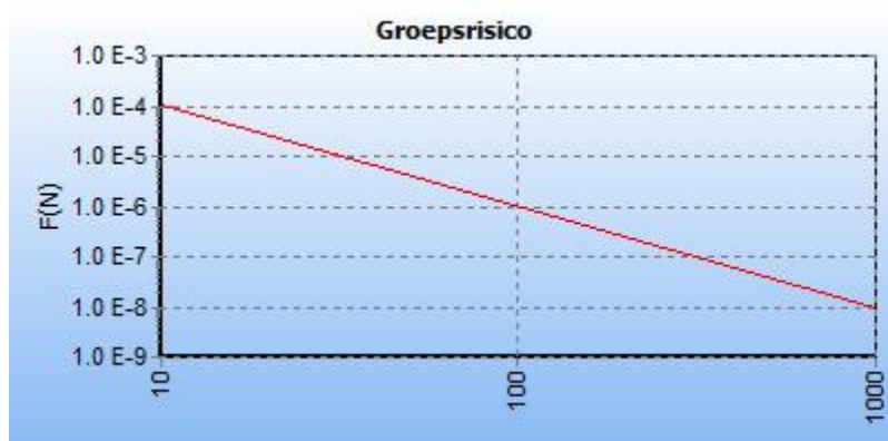
5.2 Figuur 5.2 FN curve voor A-521 van N.V. Nederlandse Gasunie voor de kilometer tussen stationing 54030.00 en stationing 55030.00
