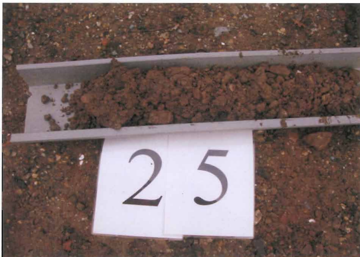
foto 5: uitkomend materiaal inspectiegat 25 (0 – 0,3 m-mv).
