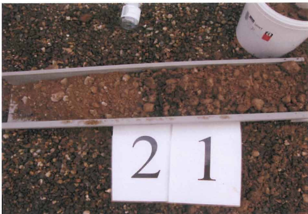
foto 3: uitkomend materiaal inspectiegat 21 (0 – 0,4 m-mv).
