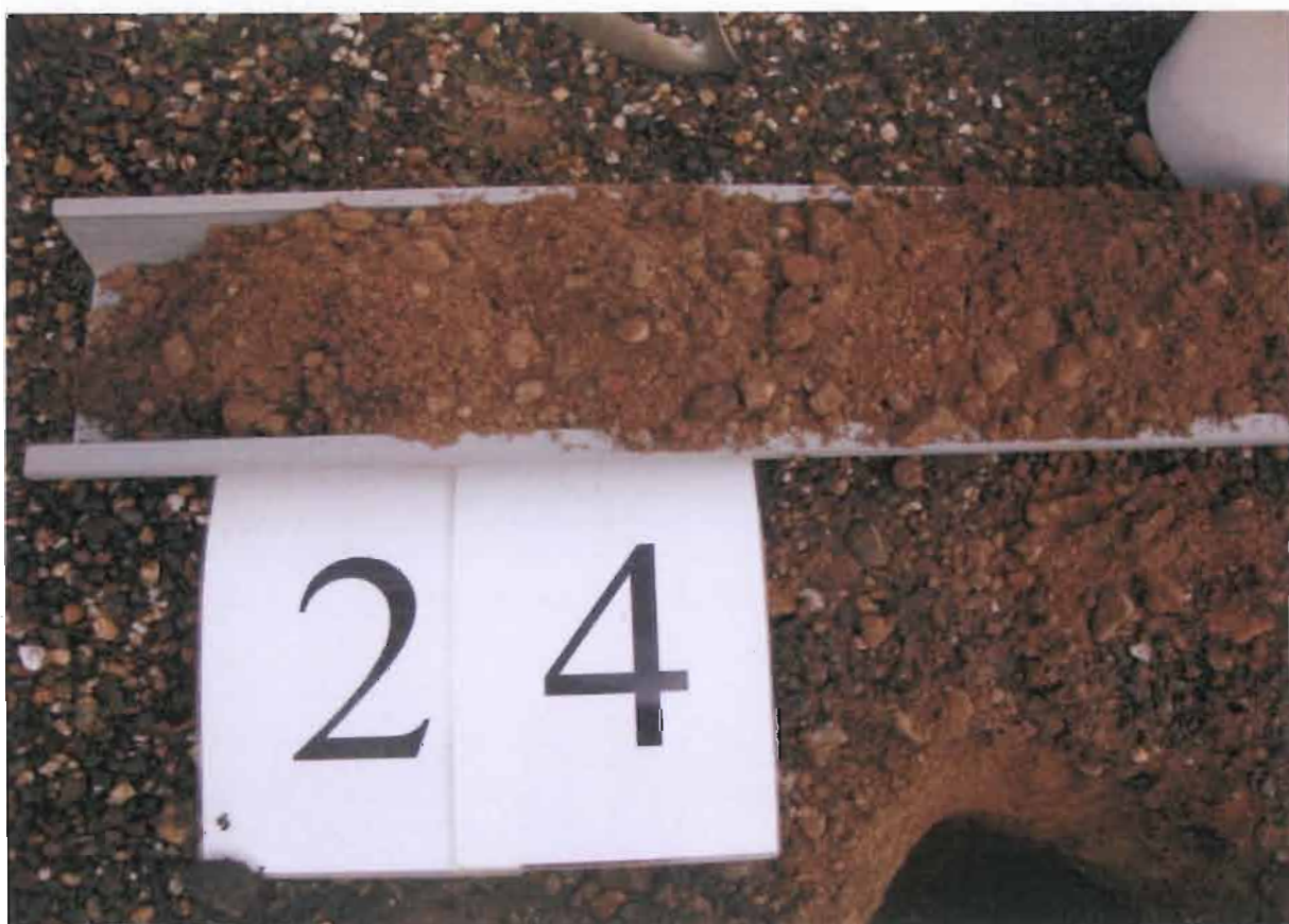
foto 4: uitkomend materiaal inspectiegat 24 (0 – 0,5 m-mv).
