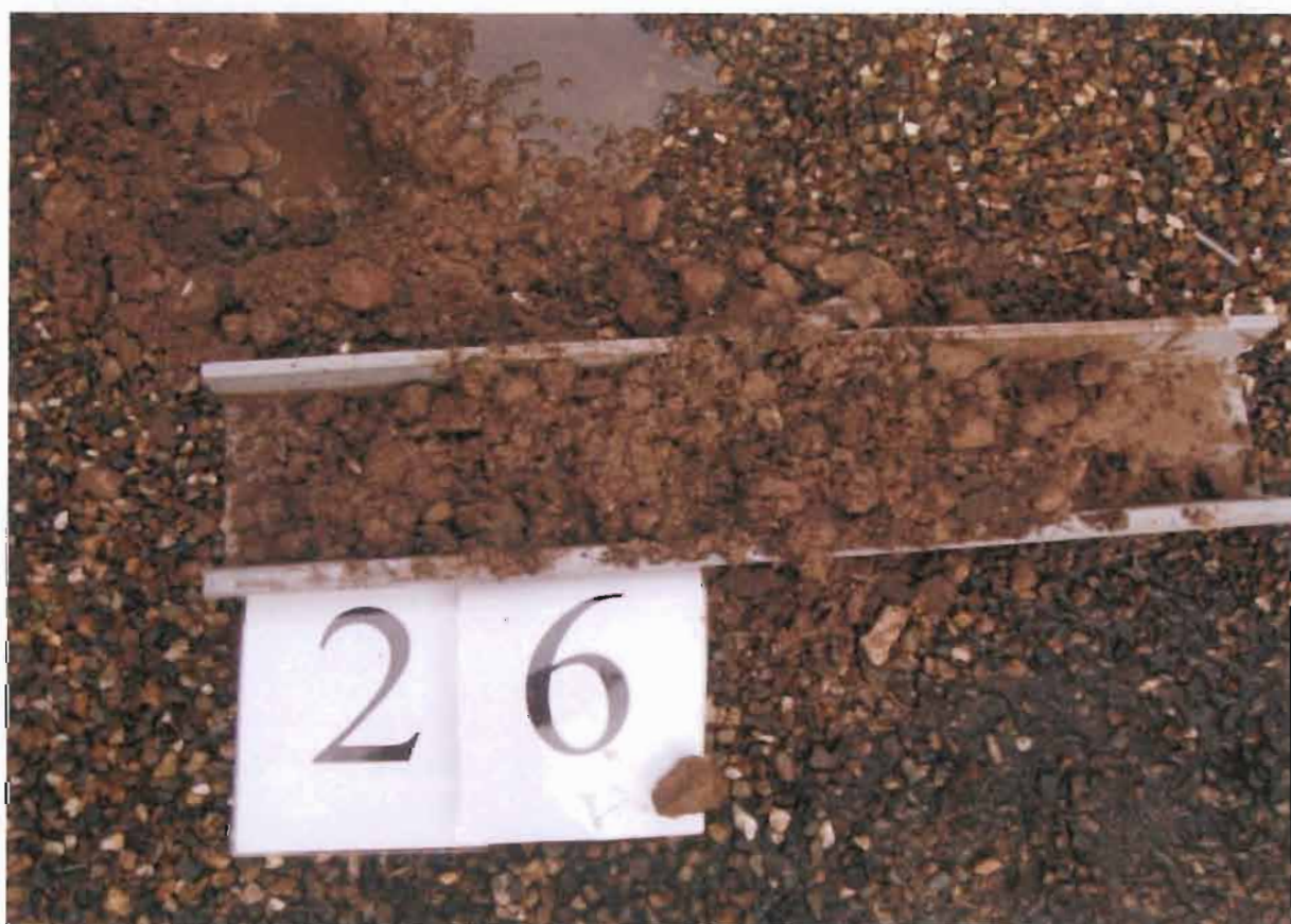
foto 6: uitkomend materiaal inspectiegat 26 (0 – 0,2 m-mv).
